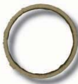
Трубопроводы для охлаждающей воды после менее чем года работы с фильтром "Tekleen".
